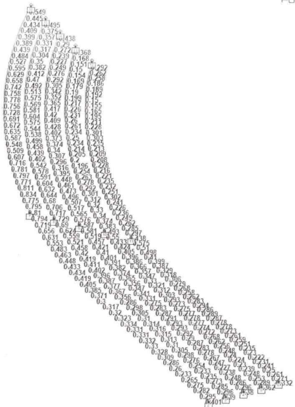
Fig. 90 Relación de esfuerzos en traves de Eje 4 a Eje 6 (ratio máximo 0.834).
