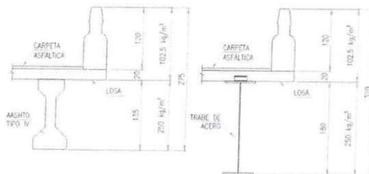
Fig. 19 Desglose de presiones de diseño en área expuesta de superestructura.
